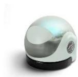
Ce robot comprend des capteurs de détection optique de couleurs et deux micromoteurs. Lorsqu'on le place sur une feuille sur laquelle on a tracé des lignes aux feutres épais et en utilisant certains codes de couleurs qui correspondent à son langage, il suit le tracé et réalise le déplacement et les mouvements programmés par les successions de couleurs.
